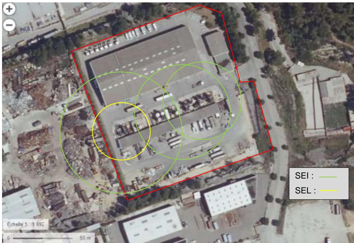
Scénario 3 : Dispersion atmosphérique des vapeurs d'HCl avec MMR.
