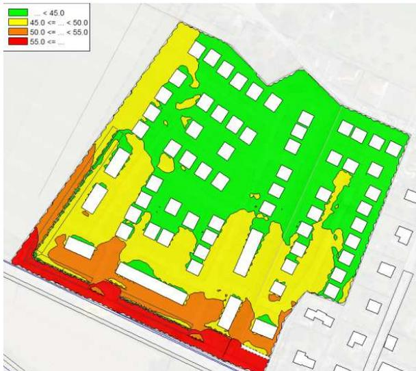
Figure 10 : Cartographie simulation / configuration 2 / récepteur 1,5 m
