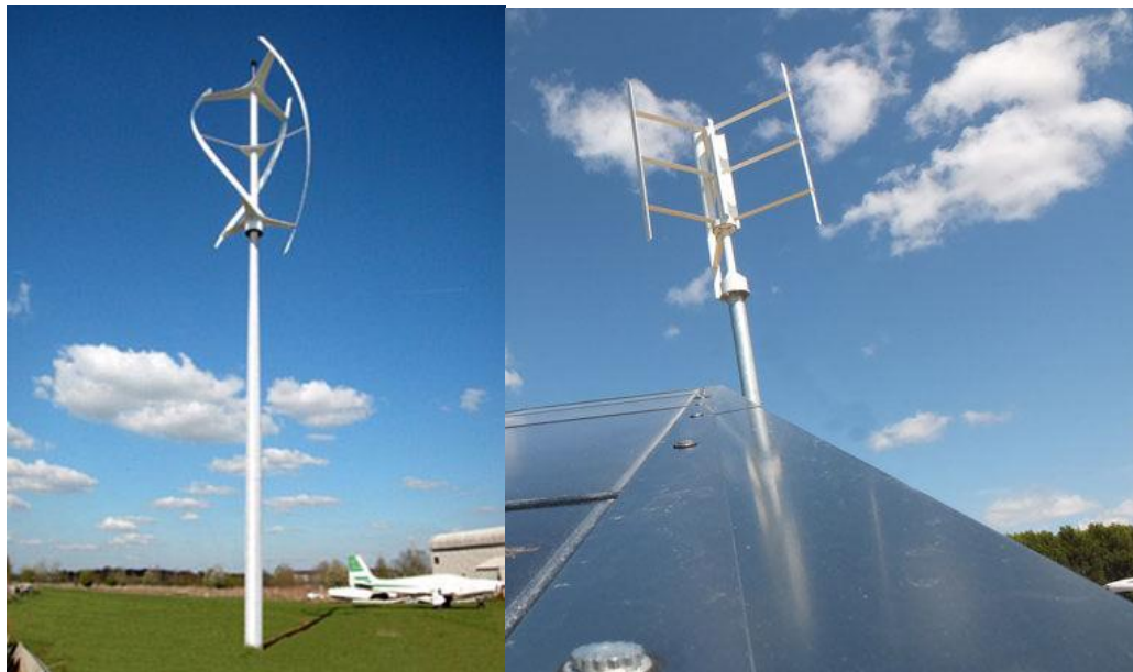
Figure 22 - Petite éolienne à axe vertical de type Darrieus (Source : Anemoos) (à gauche) et éolienne à axe vertical (Source : Qientrevolution) (à droite)
