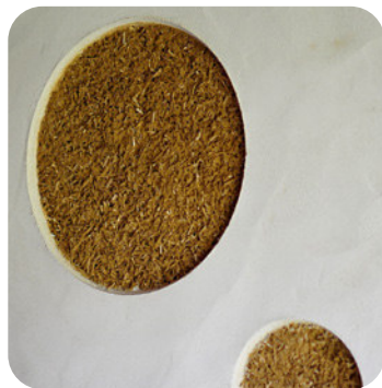
© Chanvriers en Circuits Courts - Enduit chanvre
