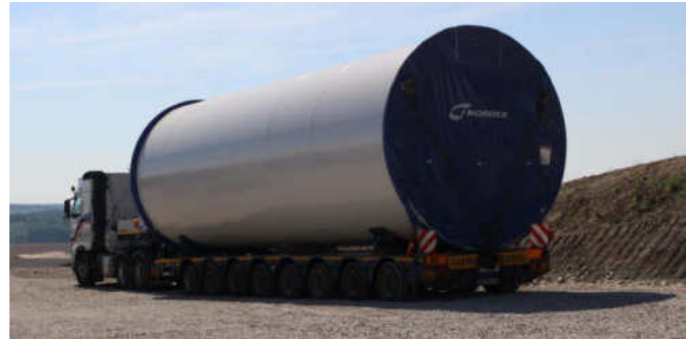
Photo 13 : Transport d'une section de mât d'éolienne (Source : Ora environnement)
