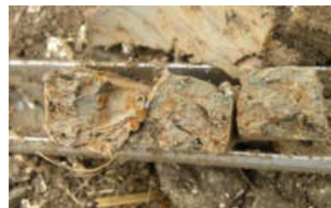
Taches de rouille et décoloration au sein d'un sol de zone humide
