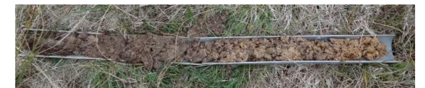
Figure 29 : Exemple d'une carotte de terre réalisée suite à un sondage
