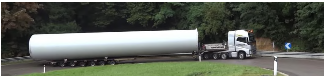
Photo 12 : Transport d'une section de mât
