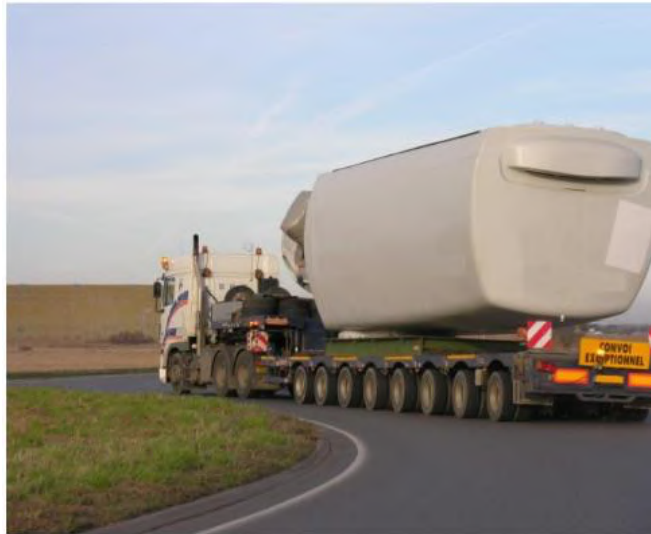
Photo 11 : Transport d'une nacelle
