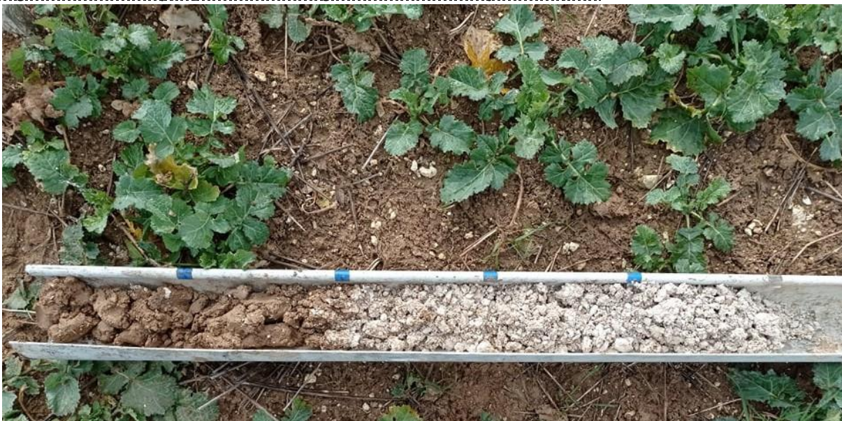
Figure 22 : Profil typique des sondages sans trace d'hydromorphie
