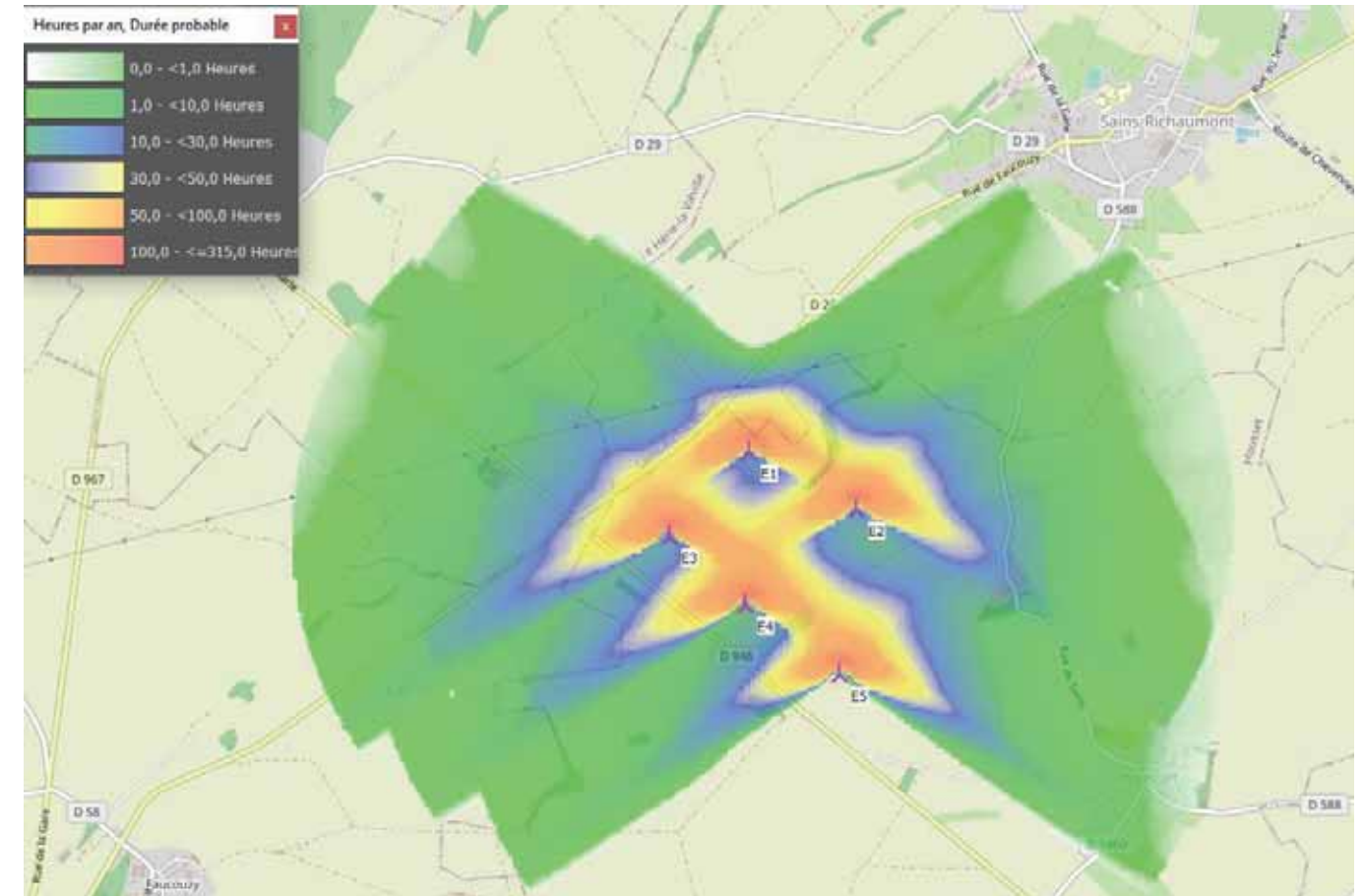
Figure 4 : Zones d'exposition aux ombres et durée probable en heures par an – Projet de Blanc Mont
