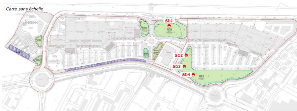
Figure 24 : Localisation des essais d'infiltration (source : ERG, 2015)
