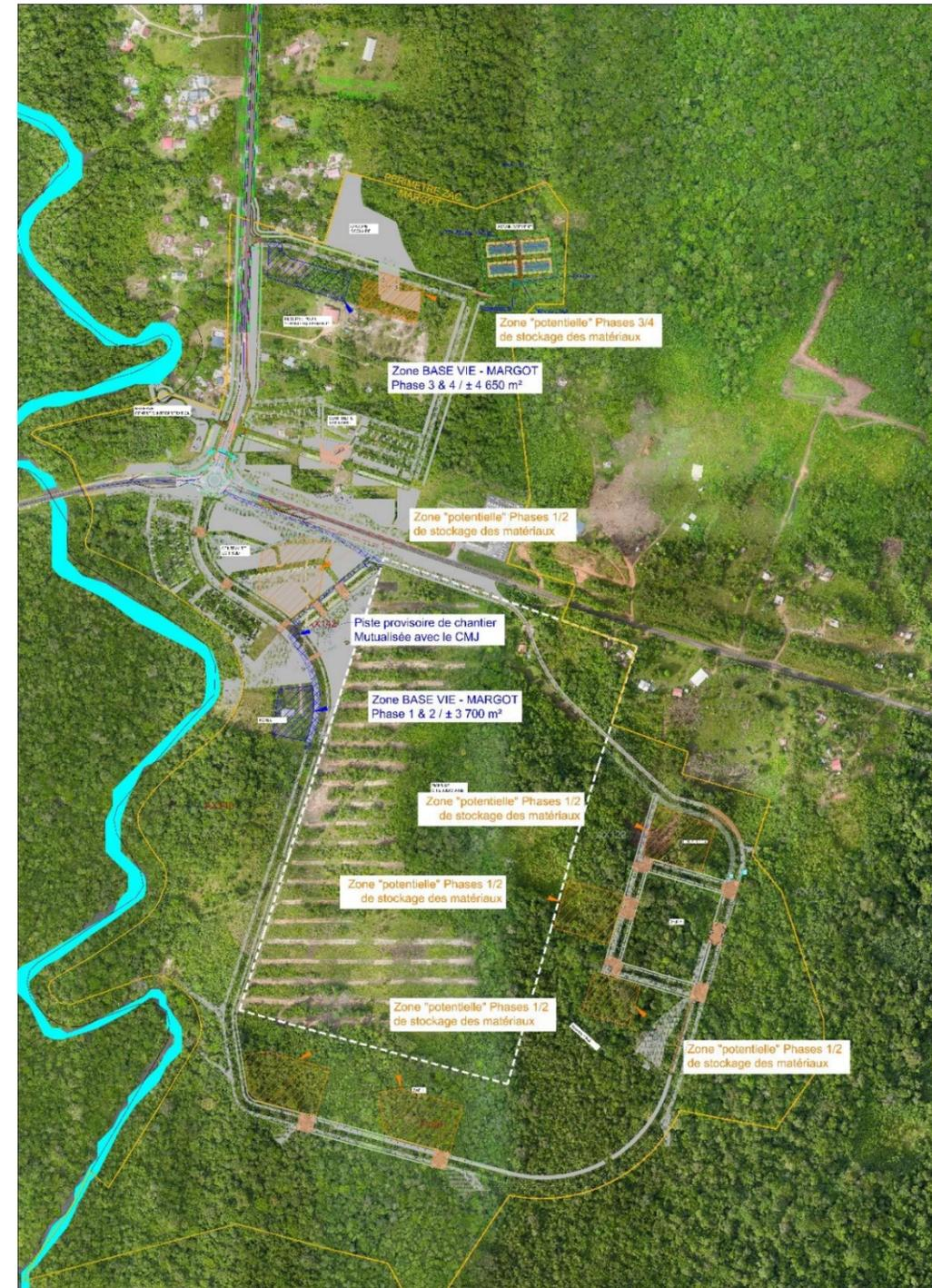
Figure 164 - Principe installations de chantier
