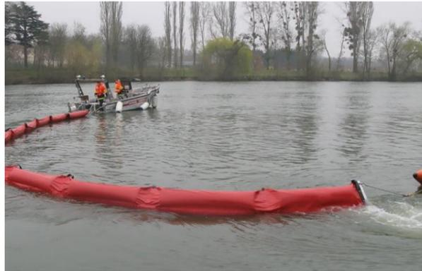
Figure 166 - Exemple de barrage flottant anti-pollution
