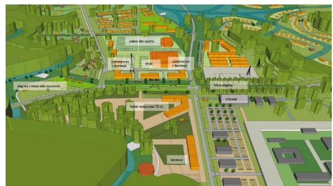
Figure 16 - Principe de dédoublement du carrefour et d'organisation des constructions le long d'une contre allée
