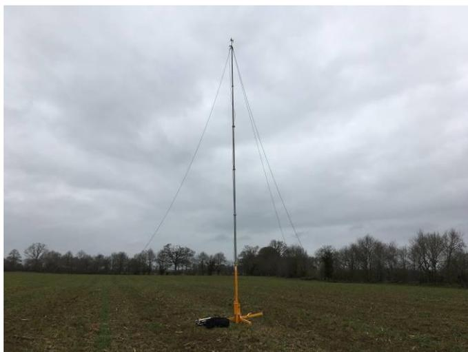
*Figure 4 : Photographie du mât de 10m installé sur site*
