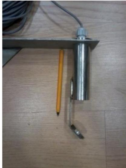
Figure 7. Illustrations d'un SM3BAT et de la protection du microphone
