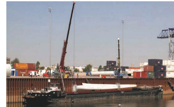
Figure 290 : Acheminement d'une pale par bateau (©ATER Environnement)
