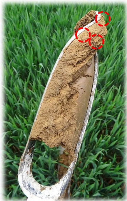
Sondage n°16 – traces d'oxydation aux environs de 60 cm de profondeur Luxémont-et-Villotte, mai 2021
