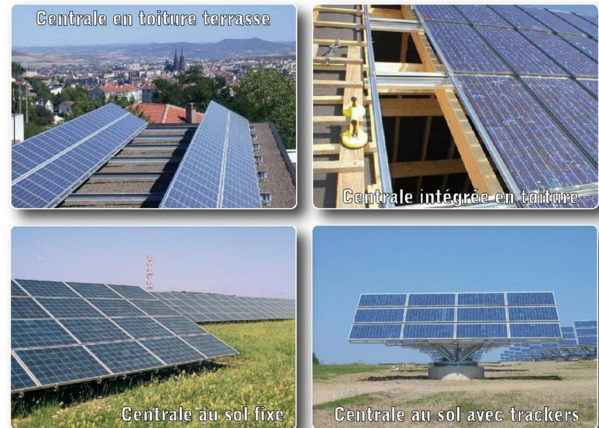
Figure 2 : Modes d'installations photovoltaïques
