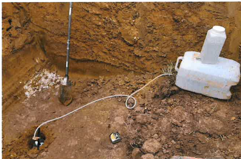
Figure 18. Test de perméabilité au droit de la fosse n°2
