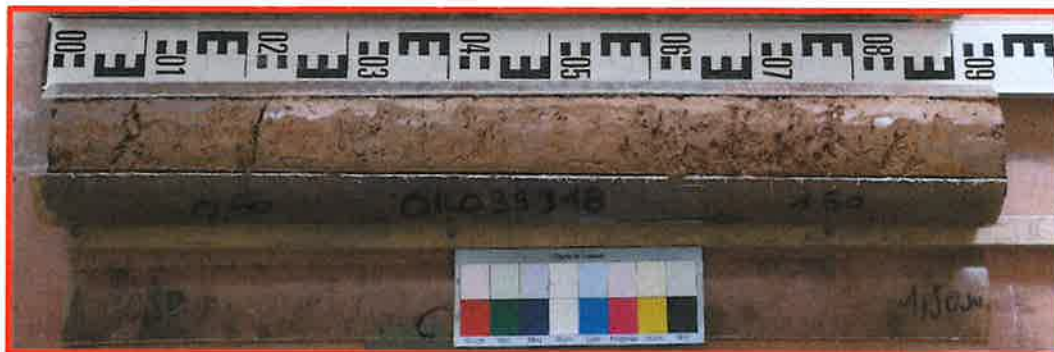
Figure 10 : Planche carotte du sondage SC1 entre 0,5-1,5 m de profondeur
