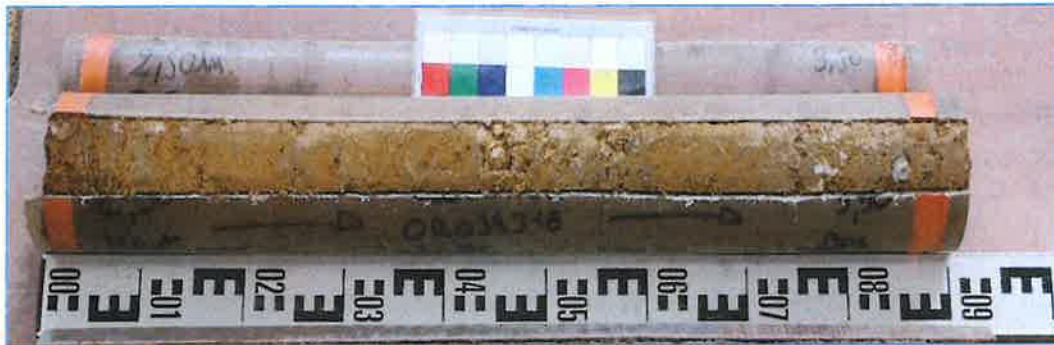
Figure 12 : Planche carotte du sondage SC1 entre 2,50 et 3,50 m
