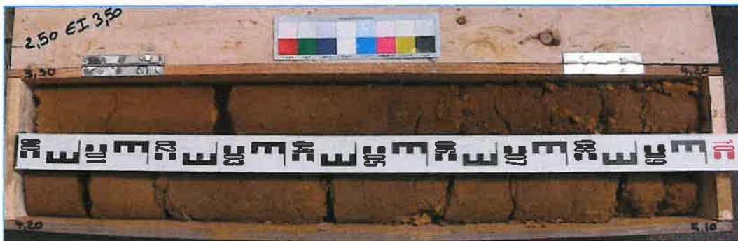
Figure 13 : Planche carotte du sondage SC1 entre 3,50 à 5,10 m
