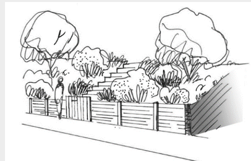
Berlinoise bois en soutènement
