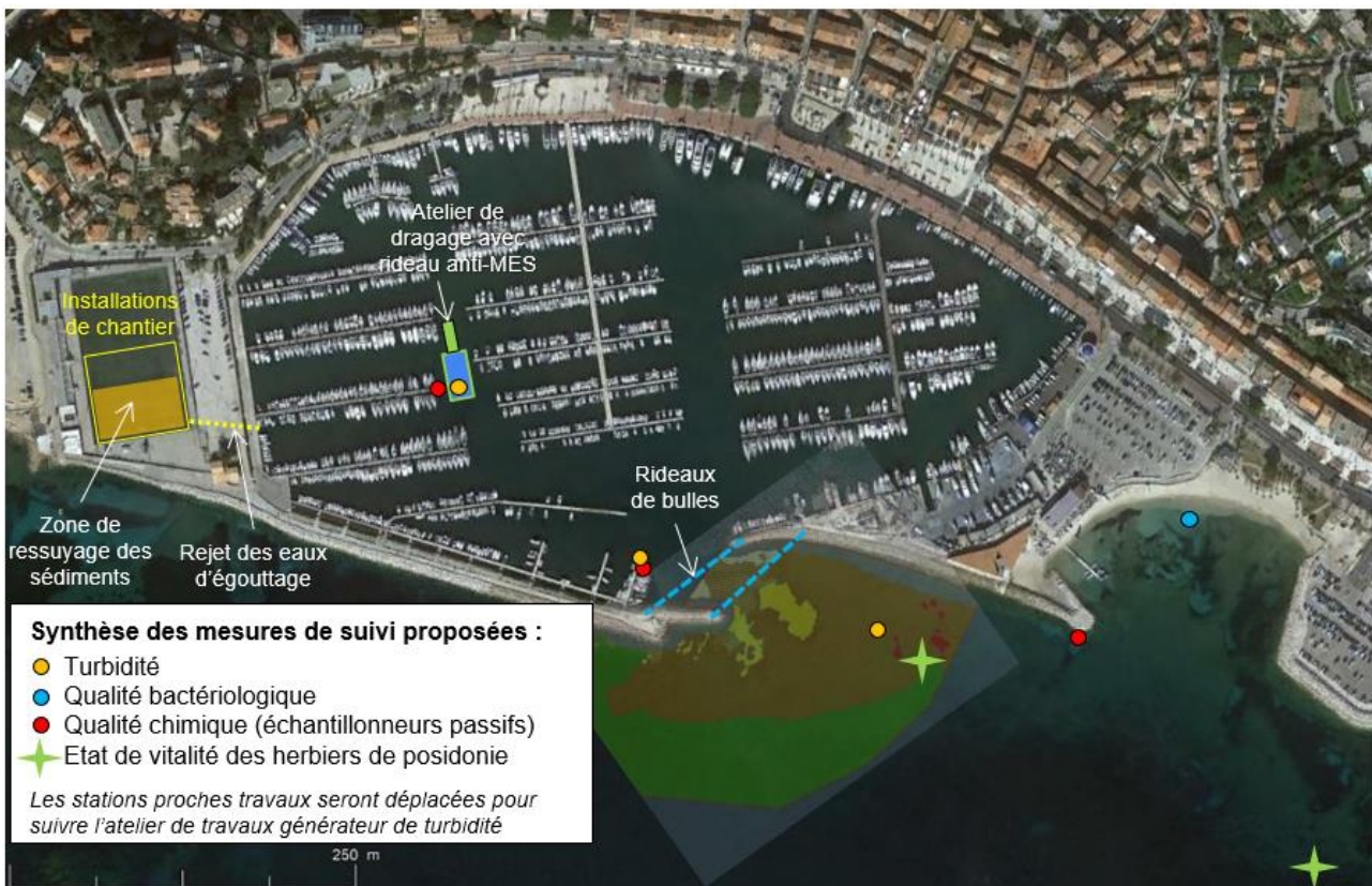
Figure 152 : Schéma de principe synthétisant les mesures de suivi du milieu marin
