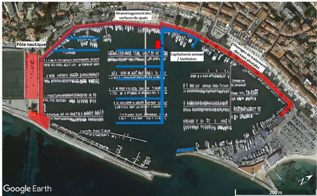
Figure 59 : Schéma de phasage des travaux
