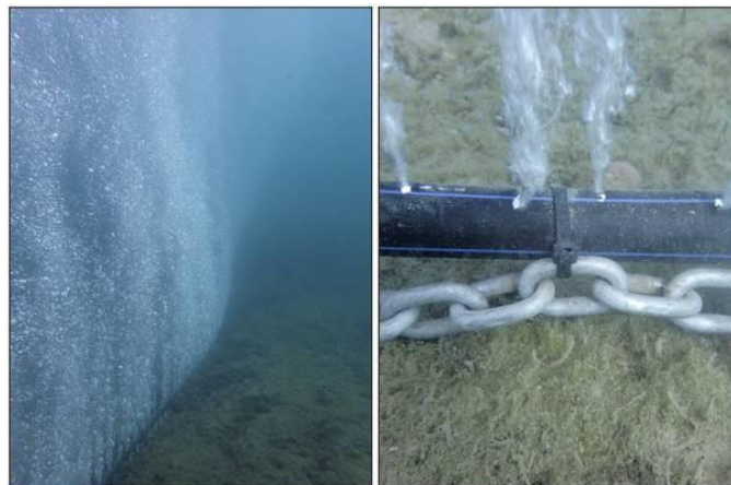
Photos sous-marine d'un rideau de bulles en fonctionnement
