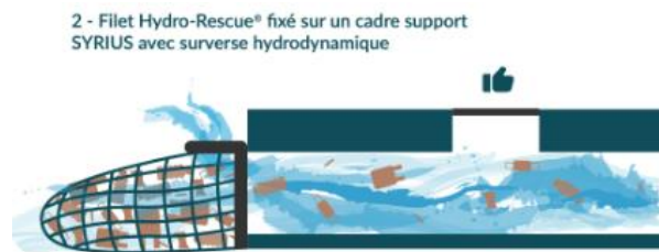
Figure 22 : Principe de filet de collecte des macrodéchets
