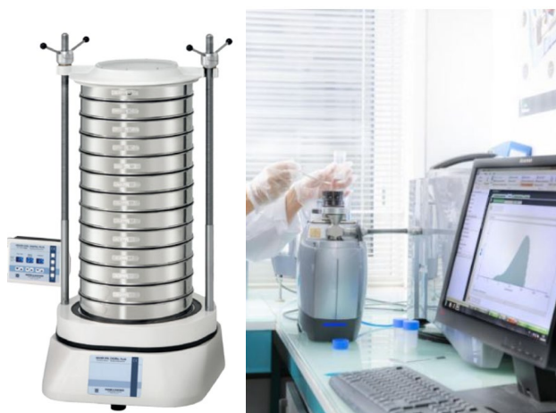
Figure 2-6 : Mise en œuvre des analyses granulométriques (par méthode mécanique à gauche, laser à droite)
