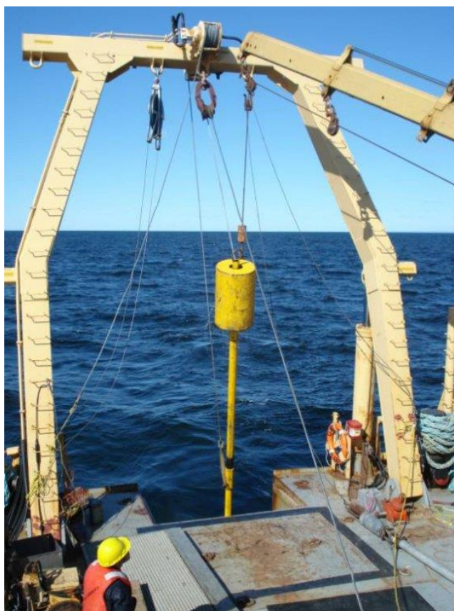
Figure 9-3: Mise en œuvre du vibro-carottier
