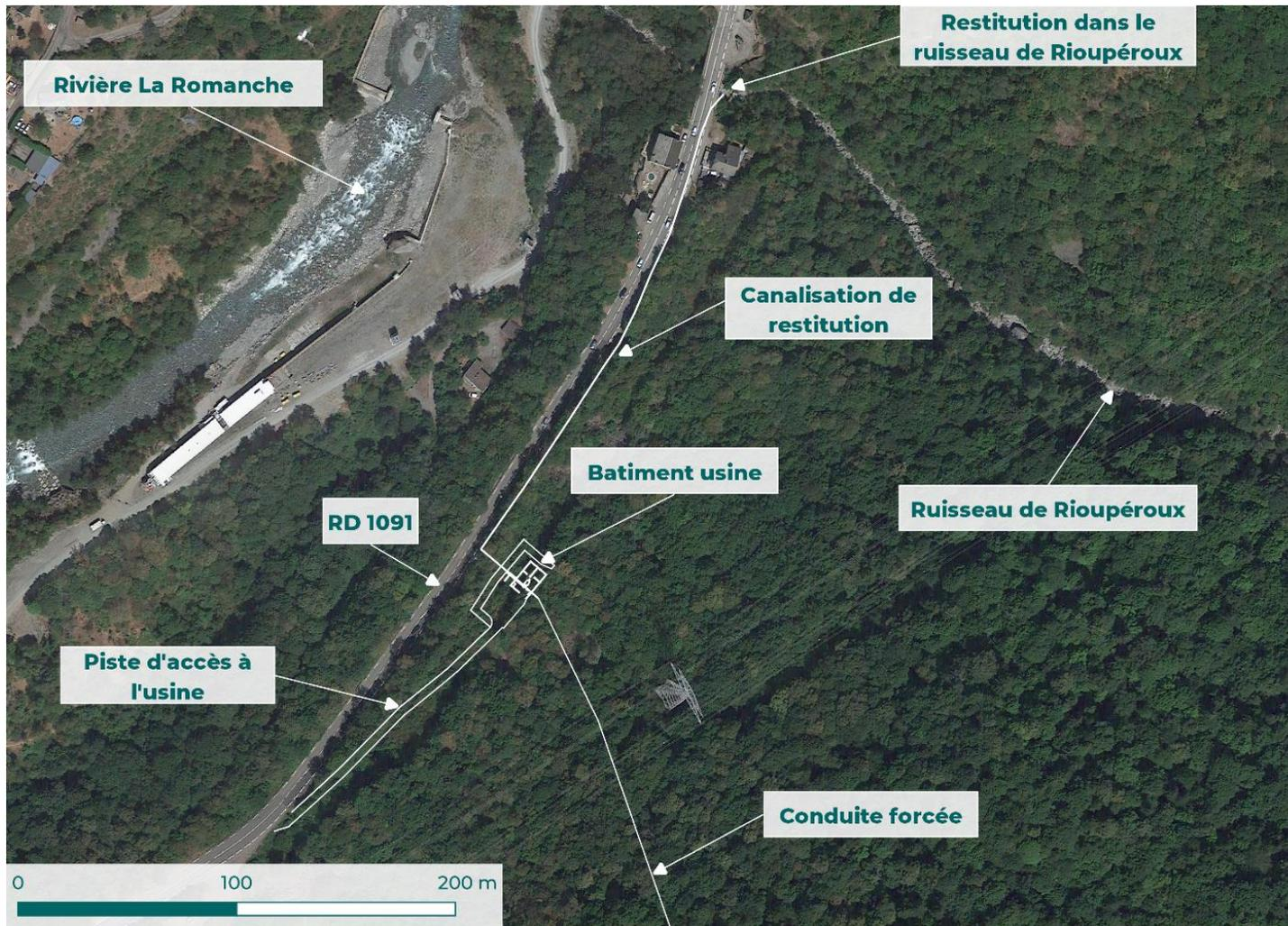
Figure 6 : Plan d'implantation de l'usine et de la restitution (le long de la route départementale)
