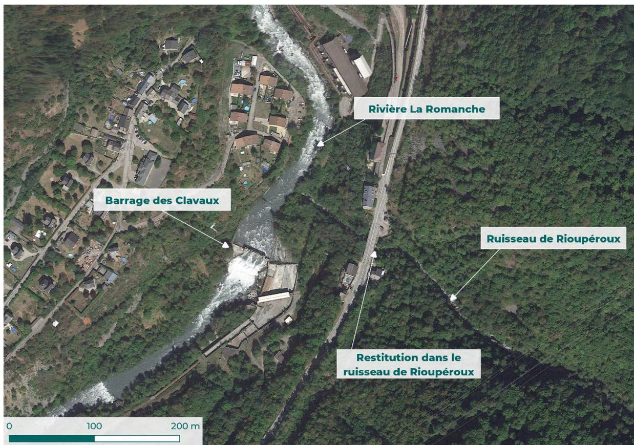
Figure 4 : Vue aérienne situant le point de restitution des eaux prélevées par la centrale dans le Rioupéroux
