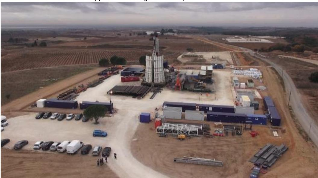
*Vue aérienne d'une plate-forme de forage (RIG)*
