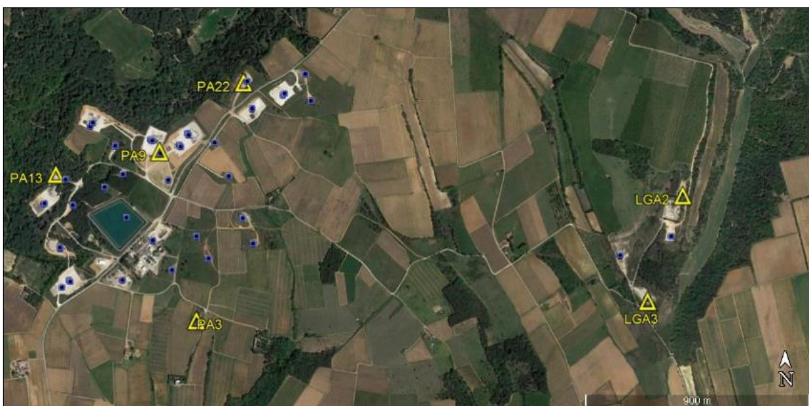
Configuration générale des capteurs de subsurface et de fond du site de Vauvert (triangles jaunes). Les points bleus représentent la position des puits.
