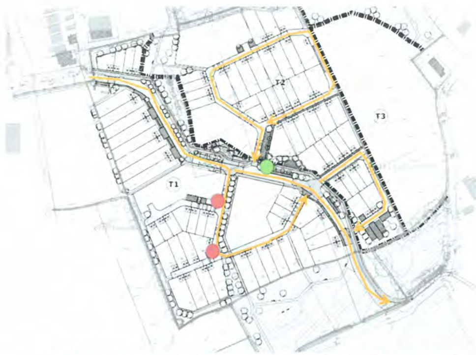
Plan de la réputation, des aires de présentation (en rouge) est du PAV verre (en vert)
