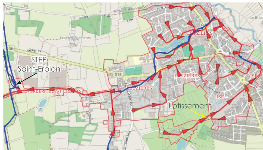
Figure 170 : Plan schématique du fonctionnement des réseaux depuis le lotissement vers la station d'épuration - Rennes Métropole, juillet 2024
