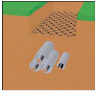
Figure 94 : Principe d'enfouissement et coupe d'un câble de raccordement souterrain (source : RTE)
