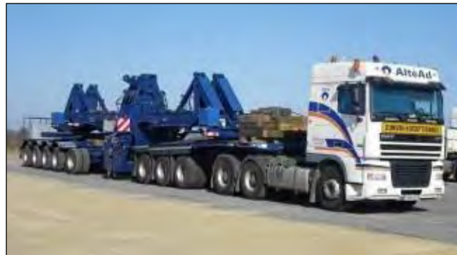
Photo 19 : Exemple de camion assurant le transport des composants d'un parc éolien
