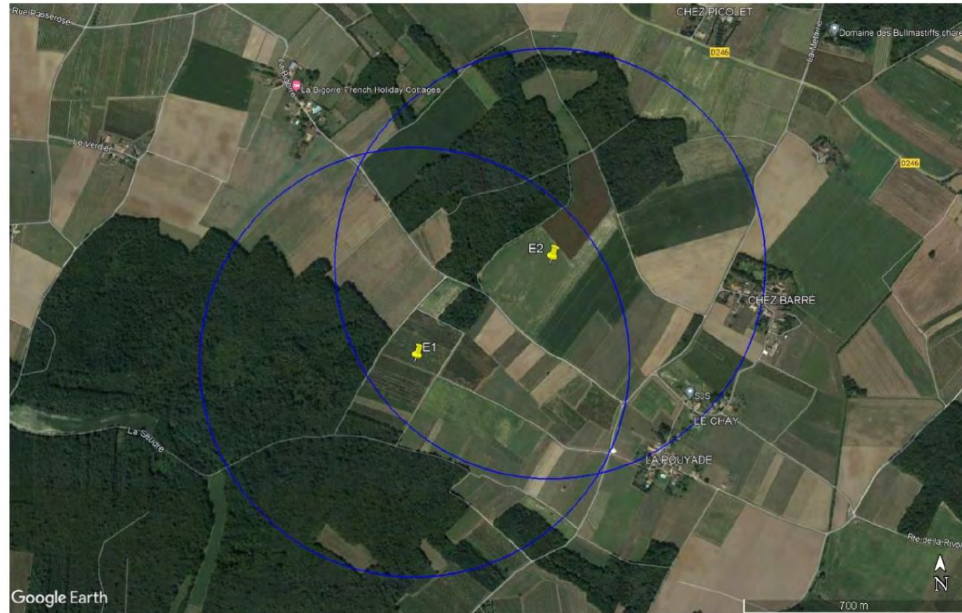
Carte 176 : Zone couverte pour la détection de la Bondrée apivore sur le site du projet avec des caméras 4K 12 mm (source : Biodiv-Wind) Épingles jaunes : éoliennes du projet // Cercles bleus : zone de couverture (682 m)
