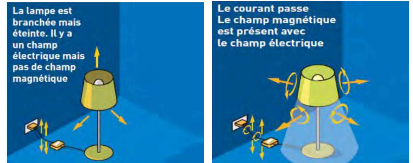
Figure 80 : Différence entre champs électrique et champ électromagnétique (Source : RTE)
