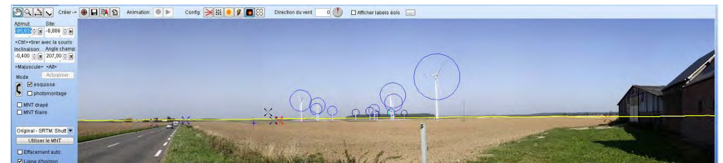
Figure 25 : principe de calage du panoramique sous WindPro
