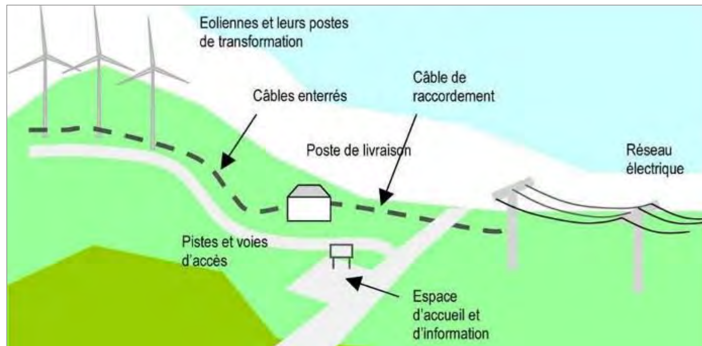
Figure 84 : Schéma de principe d'un parc éolien (Source : Guide de l'étude d'impact sur l'environnement des parcs éoliens, 2010)
