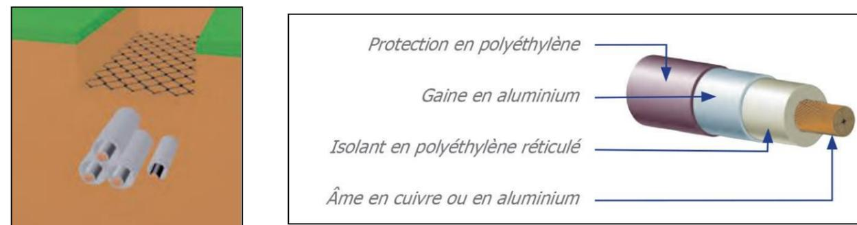
Figure 6 : Principe d'enfouissement et coupe d'un câble de raccordement souterrain (source : RTE)
