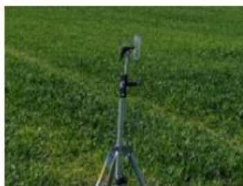
Figure 6 : Photographie du mât installé à 1,5 mètre de hauteur
