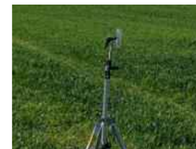
Figure 18 : Photographie du mât installé à 1,5 mètre de hauteur
