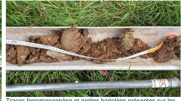
Traces ferromanganèse et argiles bariolées présentes sur les sondages humides (sondage 40) © Biotope, 2021
