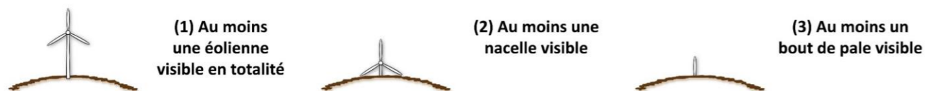
Figure 33 : Les différentes classes de visibilité en fonction de la portion d'éolienne visible
