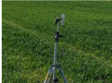
Figure 6 : Photographie du mât installé à 1,5 mètre de hauteur
