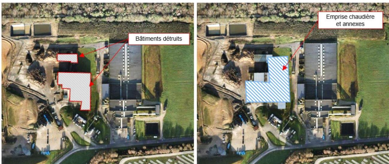
Figure 6 : Agencement actuel de la plateforme de valorisation et localisation de l'emprise de la future chaudière HPCI et ses annexes
