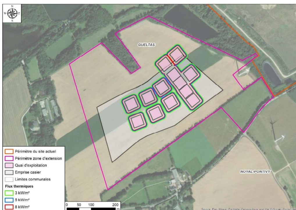
Figure 73 : Cartographie des distances d'effets aux seuils réglementaires de la cuve de gazole non routier (SUEZ, 2023)
