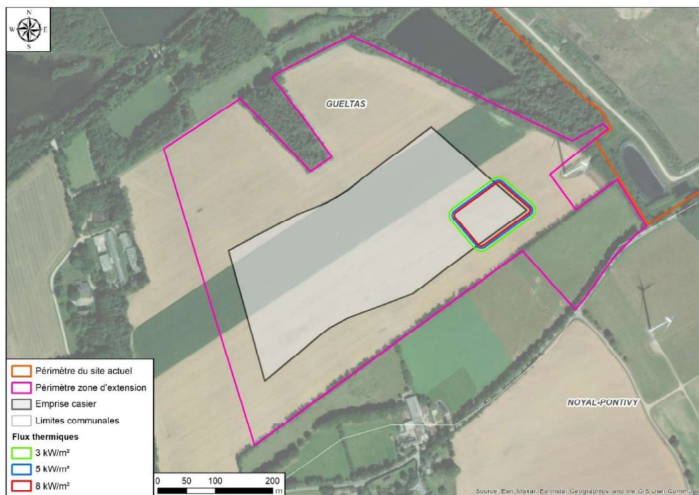
Figure 72 : Cartographie des distances d'effets aux seuils réglementaires de l'incendie de la future zone de stockage de déchets au niveau de la subdivision 5 (SUEZ, 2023)
