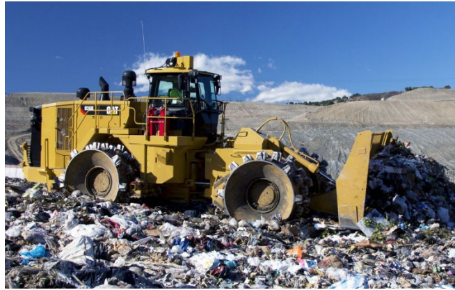
Figure 122 : Compacteur en fonctionnement
