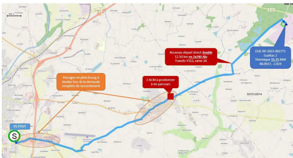
Figure 37: Tracé prévisionnel de la solution de raccordement
