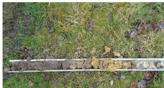
Figure 50 : Sondage avec 3 horizons visibles et distincts (non humide en noir, rédoxique en orange et réductique en gris) (Source : Diagnostic écologique DERVENN)
