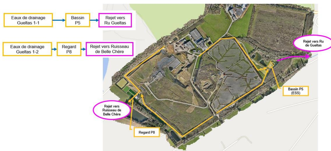
Figure 157 : Gestion des eaux de drainage sous les casiers (eaux de subsurface) actuelle
