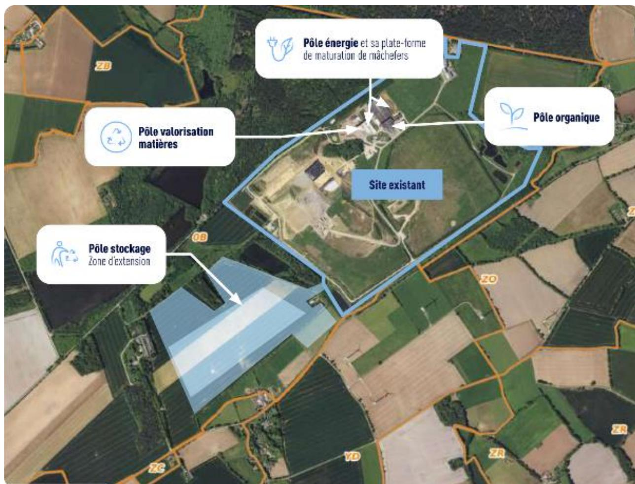
**Figure 3.** Schéma de répartition des différents pôles au sein de l'éco pôle de Gueltas
