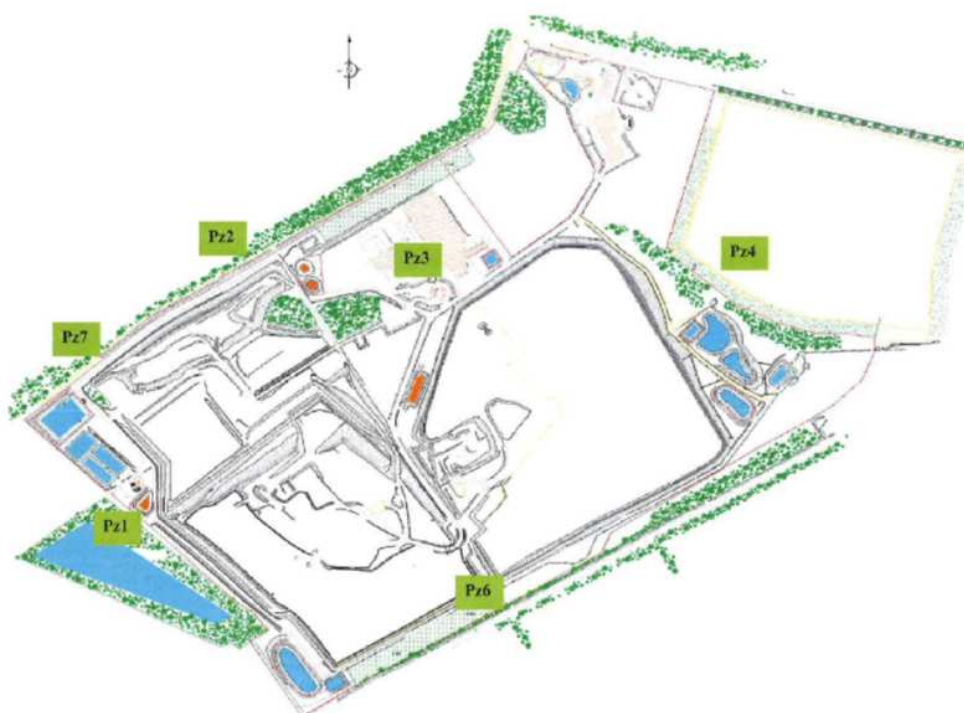
Figure 18 : Localisation des piézomètres du site (Source : SUEZ R&V Ouest)
