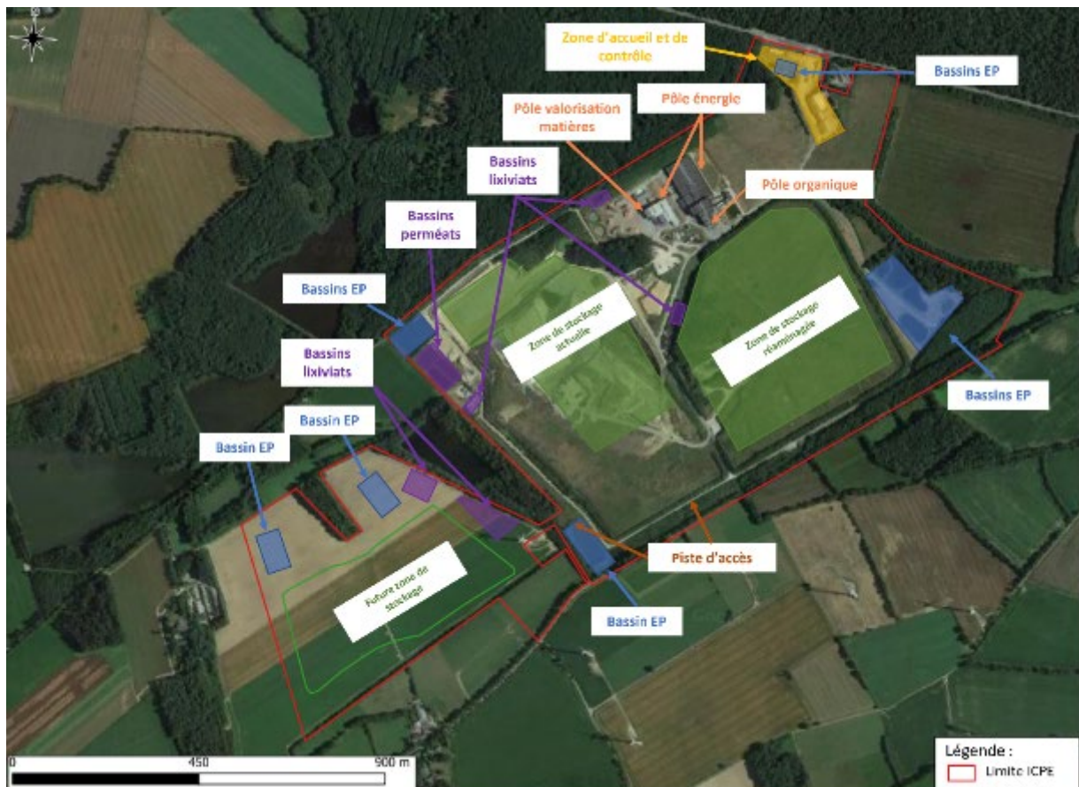
Figure 4 : Vue aérienne du site du projet et installations envisagées (Source : SUEZ Consulting)
