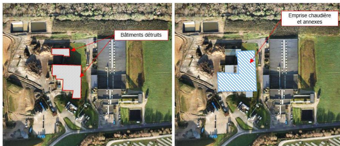
Figure 13. Agencement actuel de la plateforme de valorisation et localisation de l'emprise de la future chaudière HPCI et ses annexes
