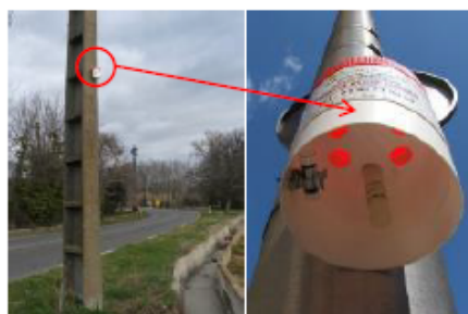
Boîte contenant un capteur NO 2 et un capteur BTEX
