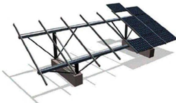
**Figure 8 : Type de longrines béton**
