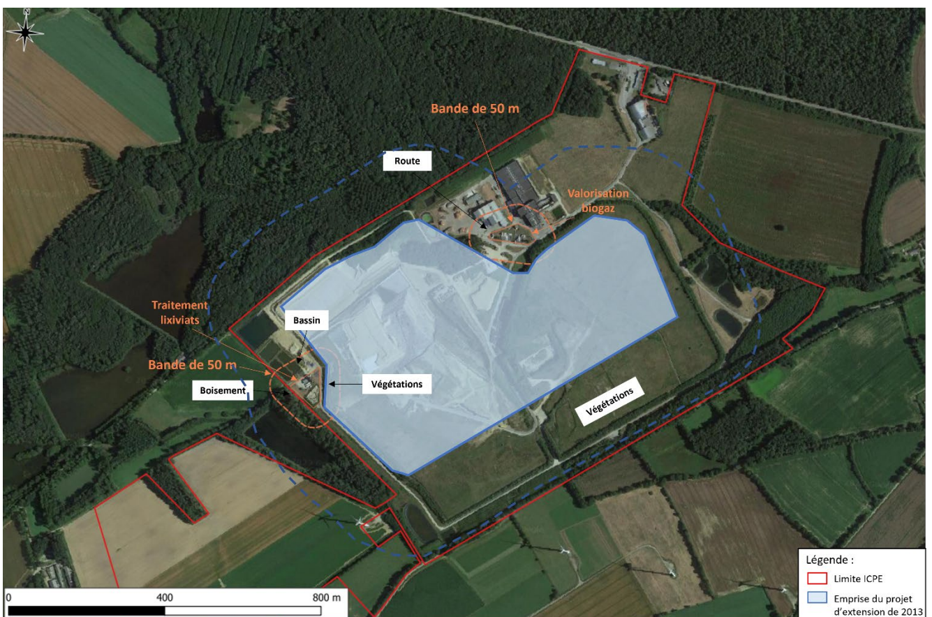
Figure 20 : Occupation des sols au sein de la bande d’isolement de 50 m (Source : SUEZ Consulting)
