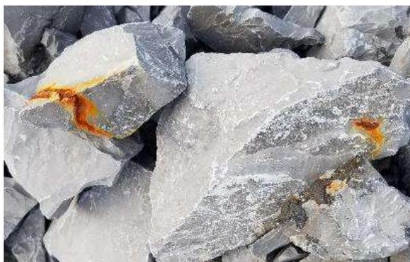
*Photo des traces d'oxydes retrouvées dans les calcaires exploités par la carrière*
