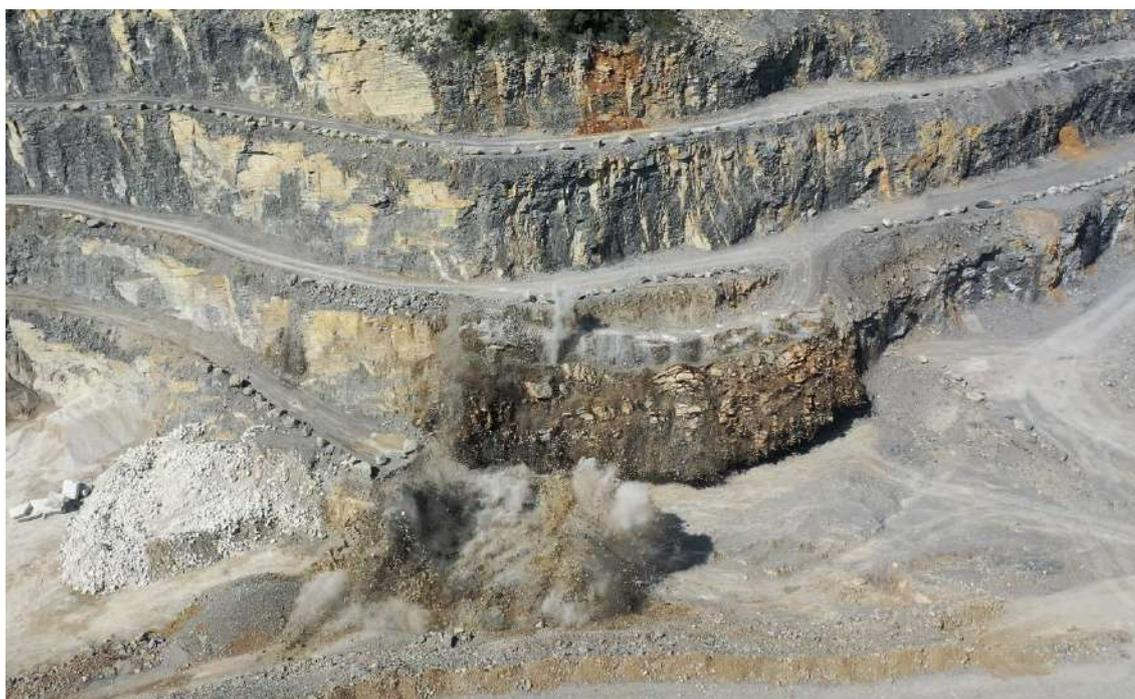
Figure 21 : Photographie d'un tir de mine
