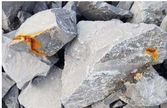
Figure 30 : Photo des traces d'oxydes retrouvées dans les calcaires exploités par la carrière
